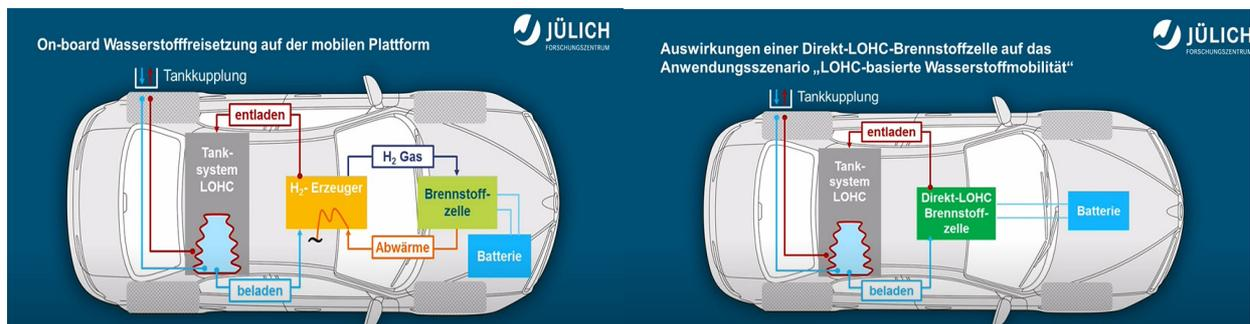
Abb. 15 Gegenüberstellung von LOHC Long Range Extender und LOHC-Direkt-Brennstoffzelle [51]
