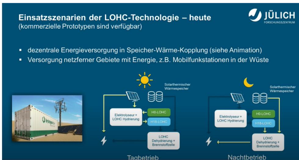
Abb. 14 Dezentrale Energieversorgung mit LOHC Technologie [51]
